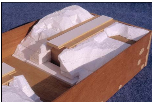
Mise en place du relief dans le caisson
